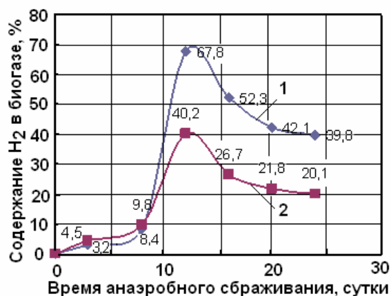
Рис.2. Изменение содержания водорода в составе биогаза в присутствии БАВ, 5 \cdot 10^{-3} масс.%. 1 – гипсозид; 2 – спиростан.
